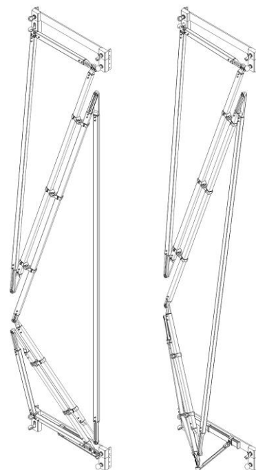
Skica 6. detaljan izometrijski prikaz noseće konstrukcije jednog fasadnog panela u zatvorenom i otvorenom položaju
