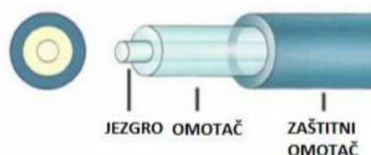
Slika 1. Struktura optičkog vlakna
