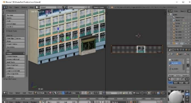
Slika 7 - Promjena razmjere UV mape
