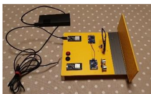
Slika 4.1- Sistem za automatsko otvaranje i zatvaranje vrata
