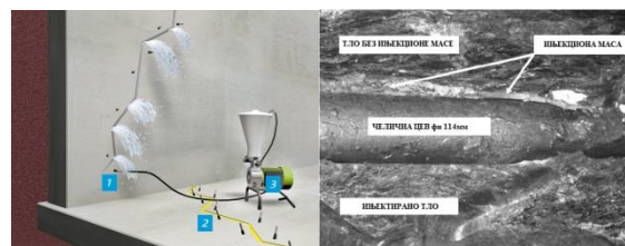
Slika 4: Sanaciono i konsolidovano injektiranje
