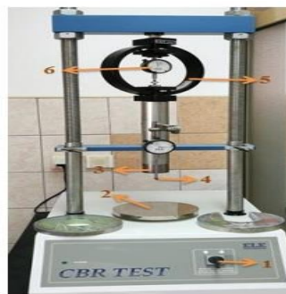
Slika 4. Uređaj za određivanje vrijednosti CBR-a
