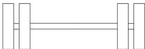
Slika 3. Jednostruka osovinica sa udvojenim točkovima
