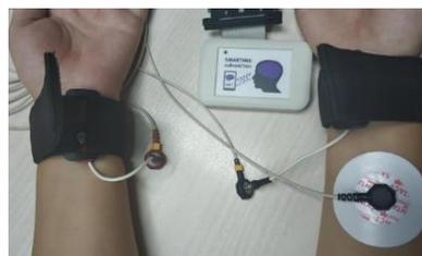
Slika 4.6. Snimanje EKG signala korišćenjem suvih elektroda
