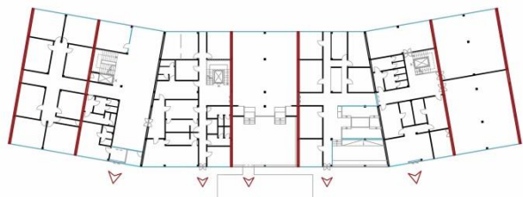
skica 8 – protivpožarna zaštita objekta
