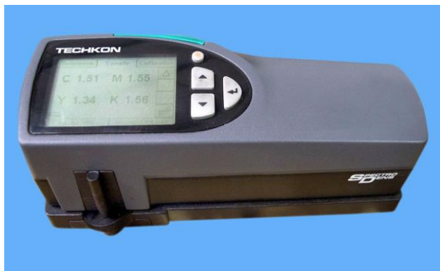
Slika 2. Technkon SpectroDens Premium [4]
