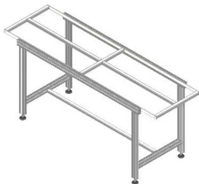
Слика 7. Приказ конструкције са укрућењем
