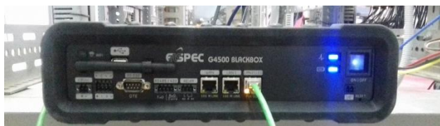
Slika 3.1. Uređaj-ELSPEC BLACKBOX G4500 [6]
