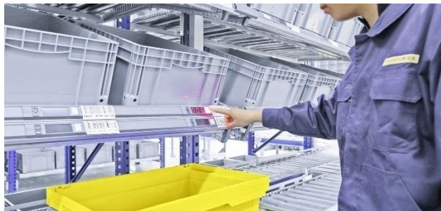
Slika 1. „Pick by light” tehnologija [4]
