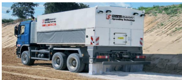
Slika 2: Nanošenje cementa pomoću cisterne
