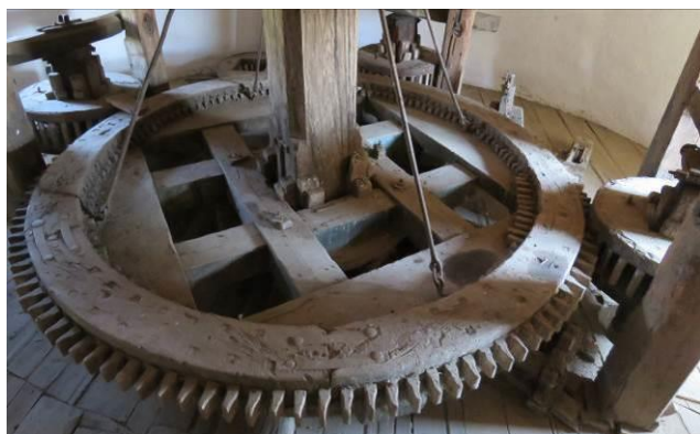
Slika br.2: Jedno brzo kolo i tri spora kola, Rodina vetrenjača
