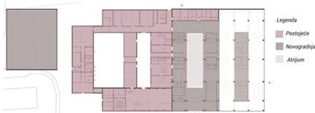
Slika 3. Šematski prikaz odnosa postojećeg i novoizgrađenog
