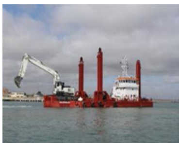
Slika 3. Bager sa čeonom kašikom
