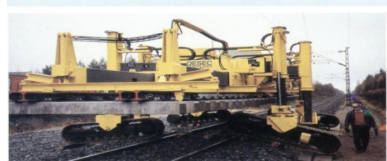
Slika 10. „DESEC“ kranovi za polaganje koloseka i skretnica [4]
