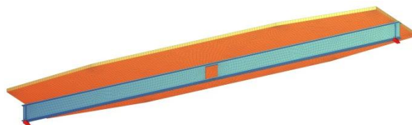
Слика 9. Модел носача са отвором ( L=15\text{ m} )
