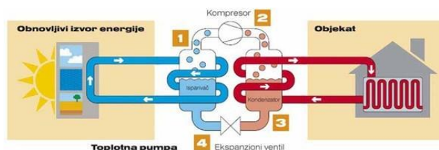
Slika 1: Princip rada toplotne pumpe
