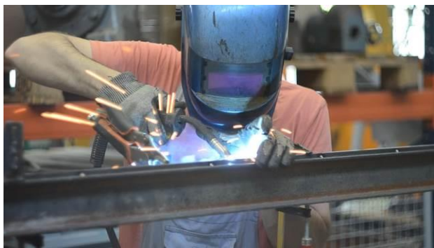
Slika 5.6 Zavarivanje kvadratne šine na IPE nosač
