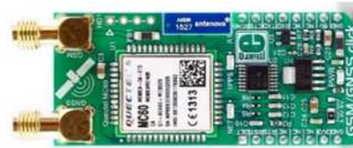
Slika 2. GSM/GNSS click modul
