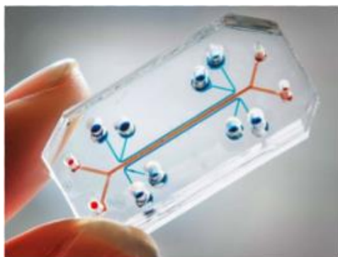
Slika 2. Izgled mikrofluidnog čipa izrađen od mekog materijala [2]
