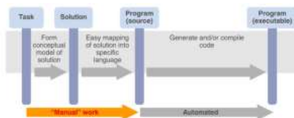
Slika 1. Proces razvoja rešenja upotrebom DSL-a [1]
