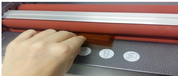
Slika 6. Radi zaštite prilikom laminiranja, slojevi se postave prvo u kaptan pa se potom ubace u laminator
