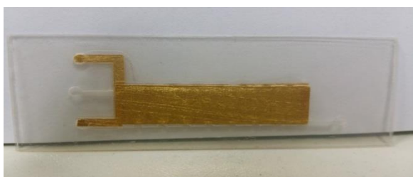
Slika 7. Prikaz krajnjeg izgleda čipa sa meandriranim kanalom
