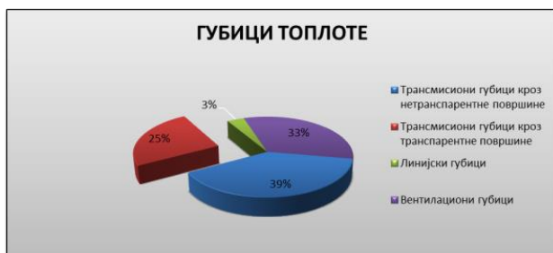
Slika 4. Gubici toplote, postojeće stanje
