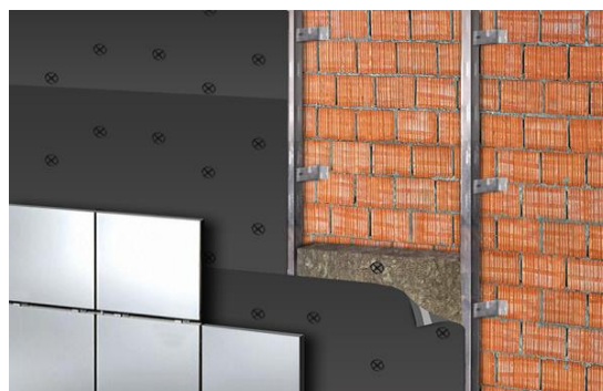
Slika 8. Izgled ventilisane fasade (potkonstrukcija, kamena vuna, ploče od Alukobonda)
