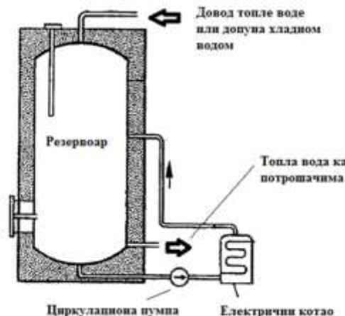
Слика 3, Акумулациони резервоар са помоћним извором топлоте [4]
