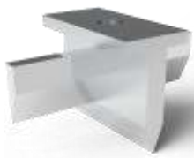
Slika 1. Ploča sa otvorom za prihvat alata u kidalici
