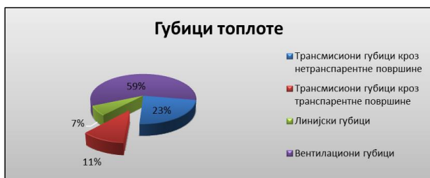
Slika 5-Gubici toplote, sanirani objekat
