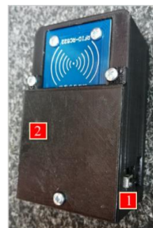
Слика 3. Сензорски RFID склоп за детекцију предмета рада [2]
