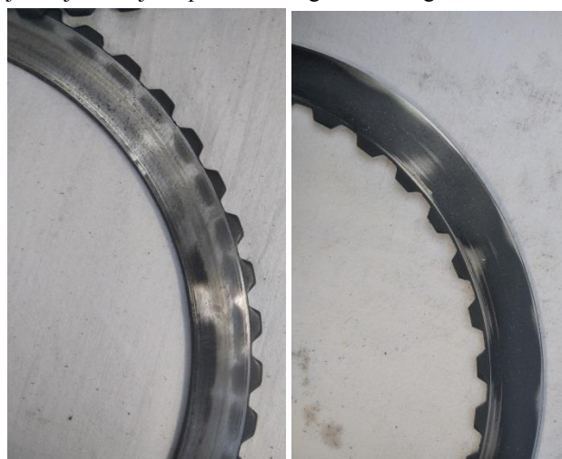
Slika 1. Primer ekstremno potrošenih lamela spojnice
