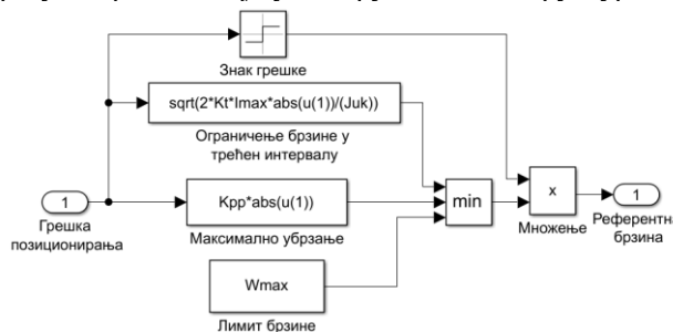
Слика 9 Реализација нелинеарног П регулатора
