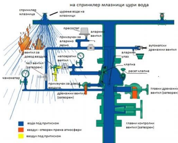
Сл.3. Истицање воде на отвореној спринклер млазници
