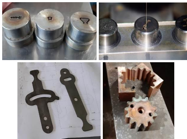
Slika 3.4 Primena WEDM mašina
