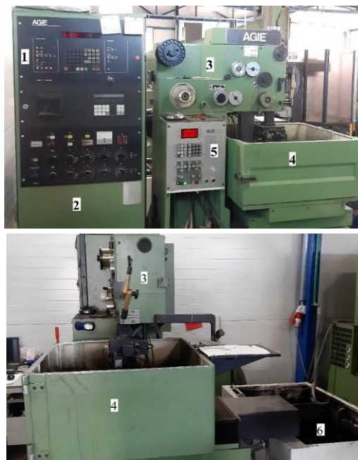
Slika 3.2 Izgled mašine AgieCut DEM 315: 1. Numeričko upravljačka jedinica (AgieMeric CNC 100), 2. Generator električnog impulsa (AgiePuls 100 D), 3. Sistem za pogon i vođenje žice, 4. Kada sa koordinatnim radnim stolom, 5. Upravljačka tabla, 6. Sistem za cirkulaciju i prečišćavanje dielektrikuma (DA 10)
