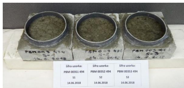
Слика 7. Испитивање на дејство мраза и соли
