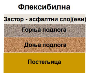
Слика 1. Слојеви флексибилне коловозне конструкције
