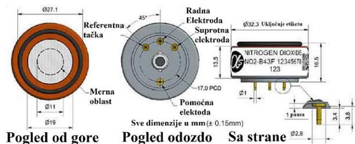
Slika 3.1 Šematski prikaz NO 2 senzora
