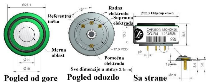
Slika 3.2 Šematski prikaz CO senzora
