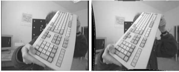
Slika 2. Uklanjanje distorzije kod široko-ugaonih sočiva
