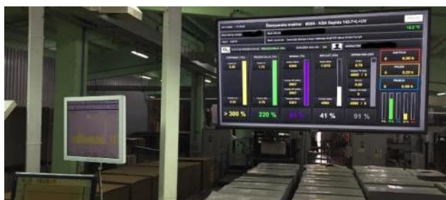
Slika 5 Ekranski prikaz MES sistema u proizvodnom pogonu u kompaniji Bosis
