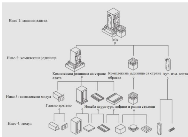
Slika 2. Hijerarhijska struktura modularno projektovanog obradnog centra [3]
