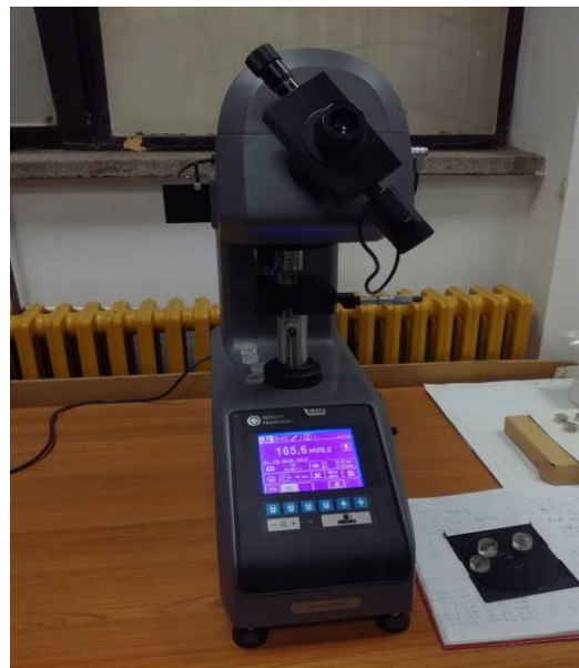
Slika 8 Uređaj za merenje mikrotvrdoće "Wilson Tukon 1102"
