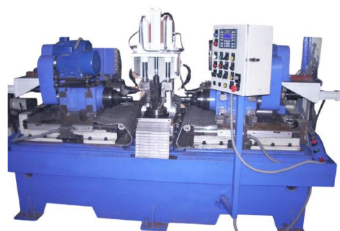
Slika 4. Fleksibilni tehnološki modul za obradu bušenjem i urezivanjem navoja, proizvođača "Patson Machines"
