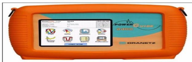
Sl. 2. Mrežni analizator Dranetz Power Guide 4400 [3]
