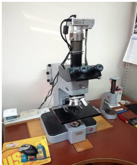
Slika 7 Svetlosni mikroskop "Leitz Ortoplan"
