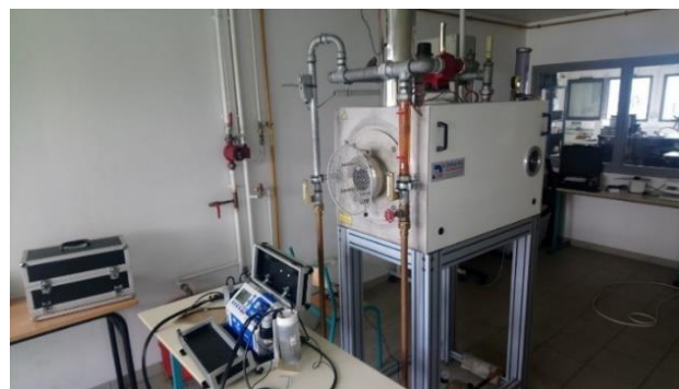
Slika 3. Eksperimentalna instalacija za ispitivanje sagorevanja
