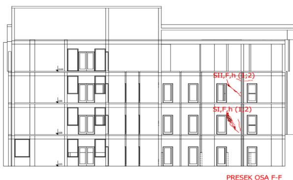
Slika 8. Podužni presek kroz osu F-F, h. Oštećenja u pregradnim zidovima od opeke
