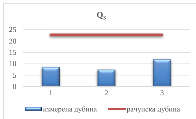
График 1: Приказ измерене и рачунске дубине на низводном крају канала за проток - Q_3
