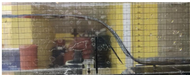
Слика 2: Приказ канала из лабораторије за случај обликованог прелива - Q_1
