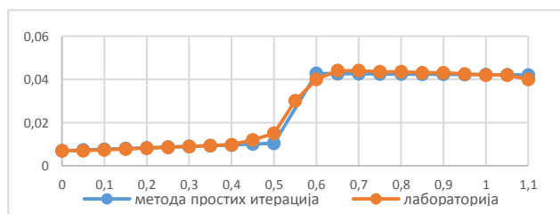
График 5: Поређење хидрауличног скока добијеног преко методе простих итерација и лабораторије ( L \approx 0.1m )
