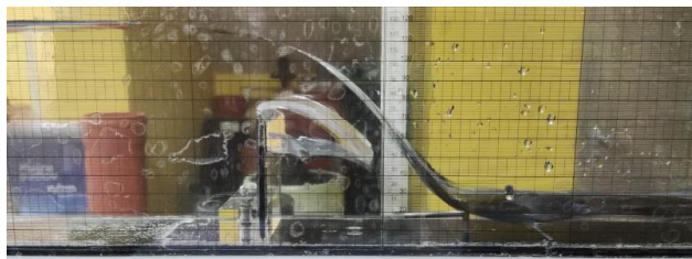
Слика 1: Приказ канала из лабораторије за случај оштрог прелива - Q_1
