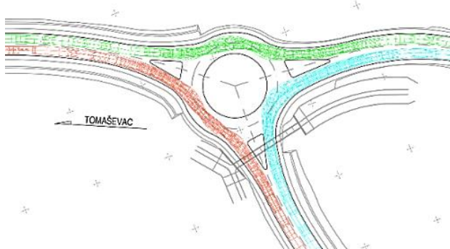
Слика 5. Проходност меродавног возила
