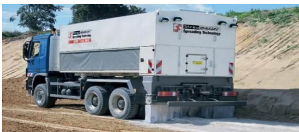
Slika 2: Nanošenje cementa pomoću cisterne
