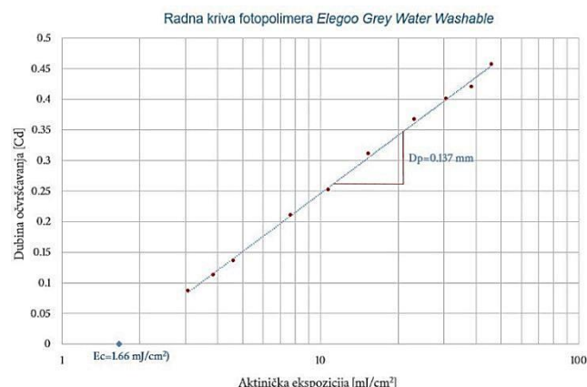
Slika 6. Radna kriva fotopolimera Elegoo Grey Water Washable
