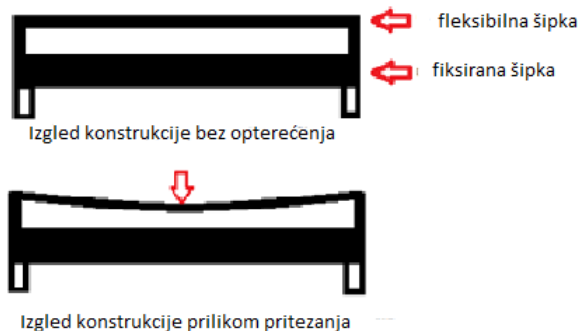
Slika 3. Konstrukcija bez i sa opterećenjem
