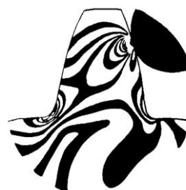
Slika 1. Prikaz koncentracije napona u zubu [1]
