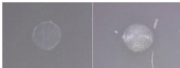
Slika 9. Mikroskopski snimak tačaka forme debljine 1.14 mm, čija je inicijalno zadatu vrednost prečnika 0.10 mm
