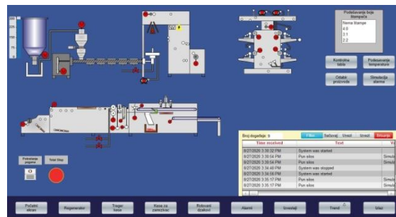
Слика 2. СКАДА апликација – приказ производне линије за производњу трегер кеса
