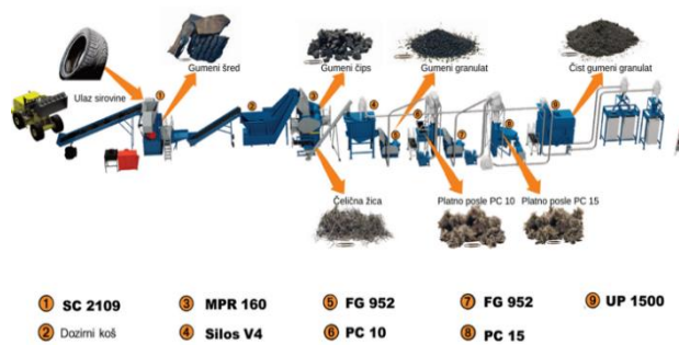
Slika 5. Ilustracija faza mehaničkog procesa recikliranja otpadnih guma u fabrici „Eco-recycling“ u Sirigu
