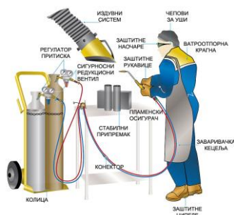
Slika 3. Ispravno i bezbedno gasno zavarivačko radno mesto
