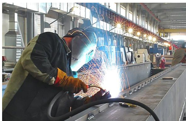
Slika 1. Zavarivanje šine za gornji pojasni lim kutijastog glavnog nosača mosne dizalice
