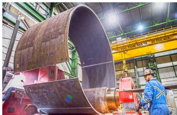
Slika 2. Kružno savijanje lima pomoću valjaka
