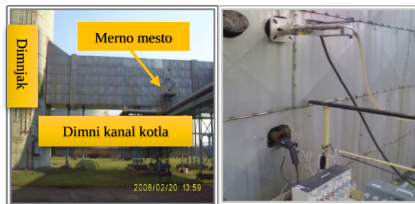
Slika 3. Položaj i izgled mernog mesta pri merenju dimnih gasova [8]
