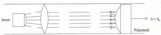
Слика 4. Комора оптичког детектора са директним светлошћу – стање без дима [4]
