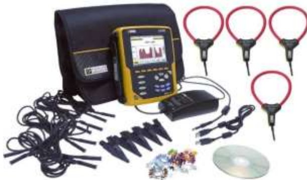
Слика 3. Мерни инструмент C.A. 8335 CHAUVIN ARNOUX са опремом [3]
