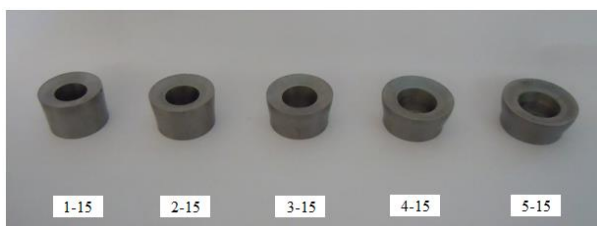
Slika 3. Uzorci ugla konusa 15^\circ nakon sabijanja
