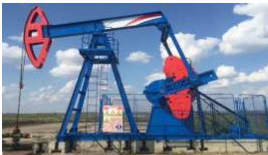
Слика 2. Дубинска клипна пумпа (качаљка) на којој су мерени параметри КЕЕ
