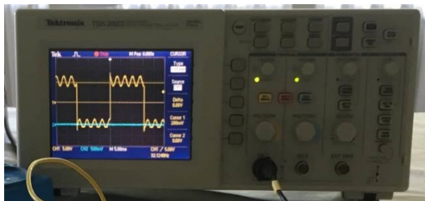
Slika 13. Sabiranje sinusoide sa ton generatora i povorke pravougaonih impulsa sa oscilatora
