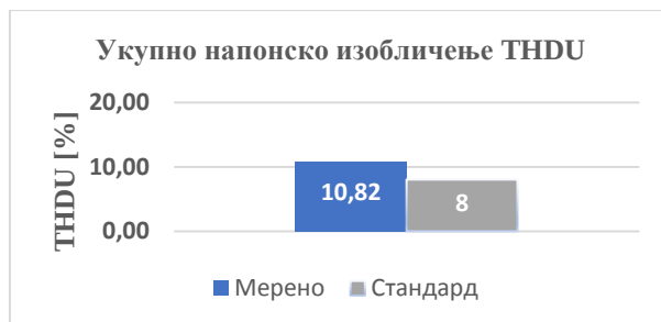
Слика 10. Граничне вредности укупног хармонијског изобличења напона THDU
