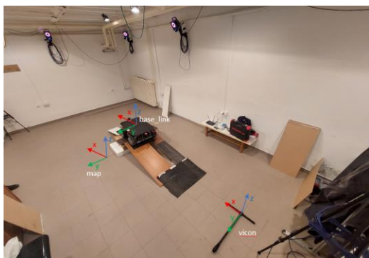
Slika 6. Kordinatni sistemi Vicon sistema, robota i mape
