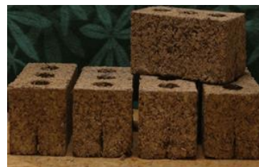
Slika 2. Blokovi od industrijske konoplje za termoizolaciju objekata [9]
