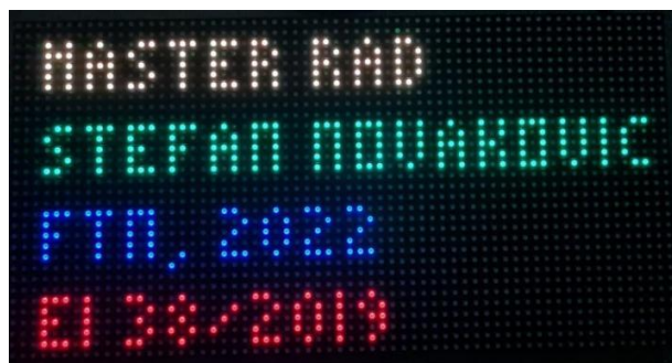
Слика 6. Испис садржаја на дисплеју помоћу C апликације
