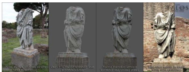
Slika 1. Prikaz celokupnog procesa dobijanja fotogrametrijskog modela.
