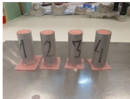
Slika 1. 4 aluminijumske epruvete napunjene sa PMMA korišćene za eksperiment
