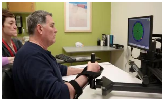
Slika 2. MIT-Manus rehabilitacioni robot
