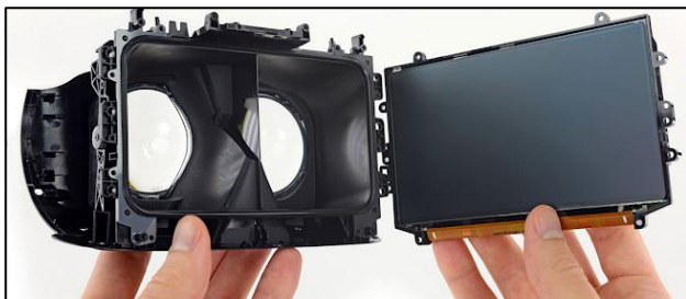
Слика 8. Пример VR хедсета са стереоскопским сочивима [8]
