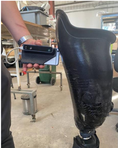
Slika 1. Proces skeniranja postojećeg ležišta ispitanika Structure Sensor skenerom
