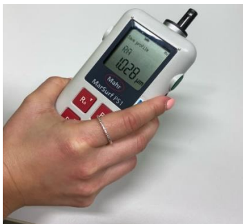
Slika 9. Uređaj za mjerenje hrapavosti MarSurf PSI
