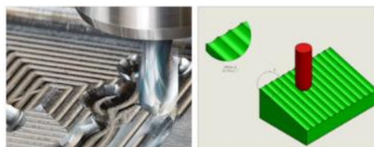
Slika 2.2: Ostatak materijala pri obradi kompleksnih površina
