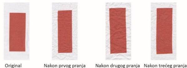
Slika 13. Skeniran uzorak kepera štampanog najmanjom rezolucijom nakon procesa pranja
