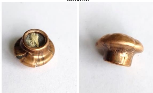
Слика 5. Изглед метка 9x19 (128) након вађења из шлема
