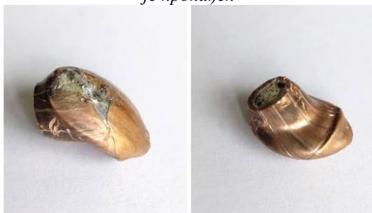
Слика 4. Изглед метка .357 FMS након вађења из шлема
