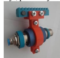
Slika 9. Sklop kliznog ventila sa zupčastom letvom
