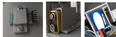
Slika 10. Držači za baterije i Bluetooth modul
