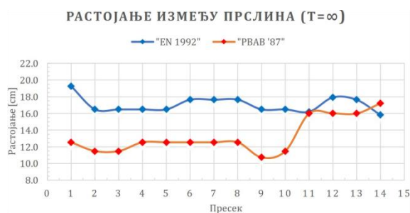
Slika 3. Rastojanje između prslina
