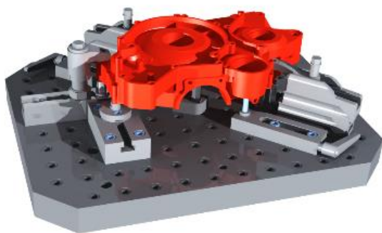
Слика 2. 3D модел модуларног прибора
