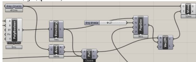
Слика 3: део кода који веже геометрију дрвећа за насумичне тачке на површи
