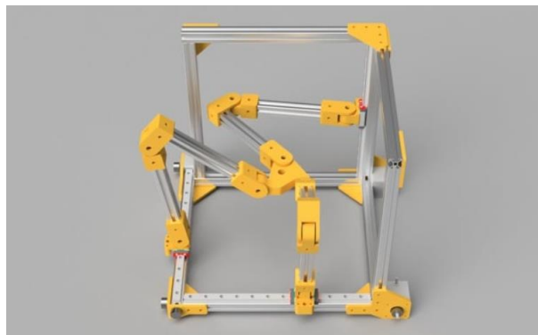
Слика 1. Кинематика декартове паралелне машине
