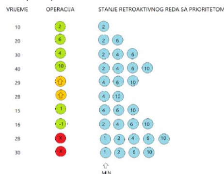
Slika 2 Prikaz promjene stanja parcijalno retroaktivnog reda sa prioritetom
