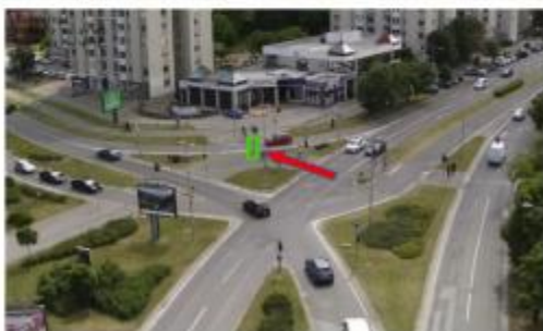
Slika 8. Primer greške praćenja (preuzimanje) bicikliste usled kratkotrajne okluzije, preklapanja sa pešakom
