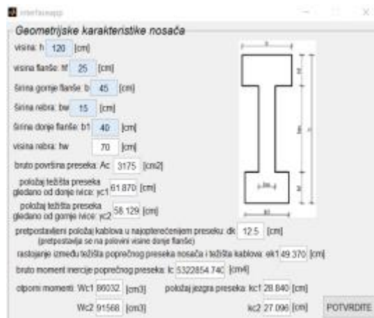
Слика 2.- Прозор за дефинисање пресека
