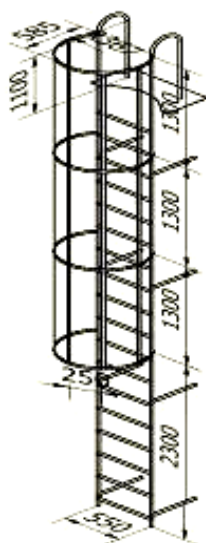
Slika 10. Fiksne merdevine sa leđobranom
