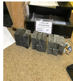
Slika 2 - Ispitivanje indeksa aktivnosti biopepela
