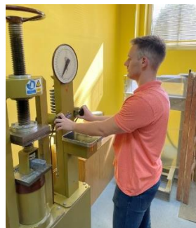
Slika 2 - Ispitivanje indeksa aktivnosti biopepela
