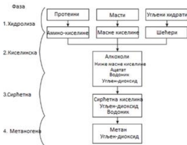
Табела 3.1 Четири фазе настанка биогаза (анаеробна ферментације) [2]
