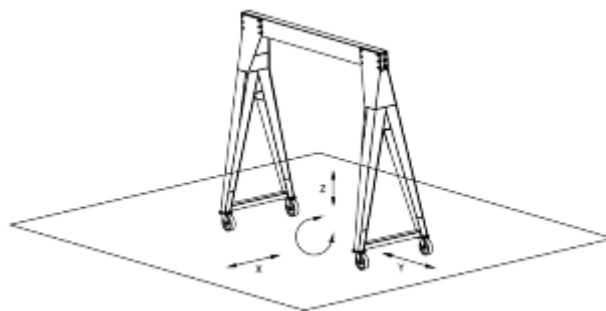
Слика 2. Могућа радна кретања радионичке порталне дизалице
