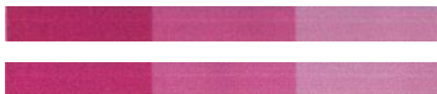
Slika 2. Skenirani uzorci magenta boje nakon uticaja trljanja na materijalu „Gold“
