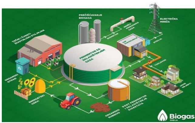
Слика 3: Технолошки процес когенерације у биогазном постројењу
