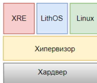
Слика 1. Архитектура система са хипервизором
