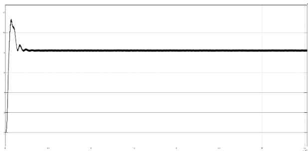
Слика 8. Струја пуњења батерије
