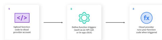
Слика 1. Приказ како serverless функција ради [9].
