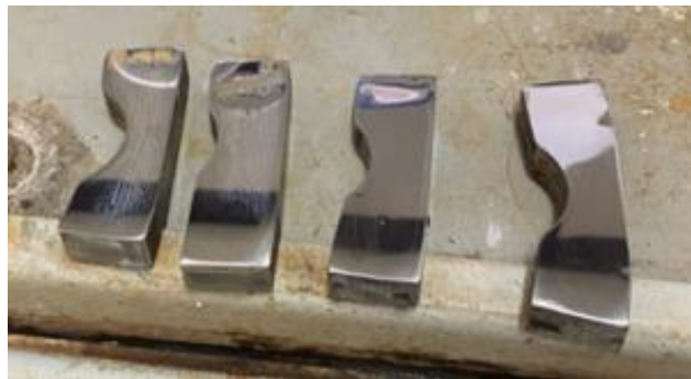
Slika 5. Ispolirani i očišćeni uzorci
