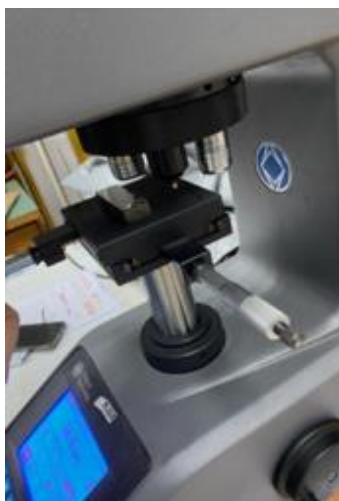
Slika 6. Proces merenja tvrdoće i merenje dijagonala otiska
