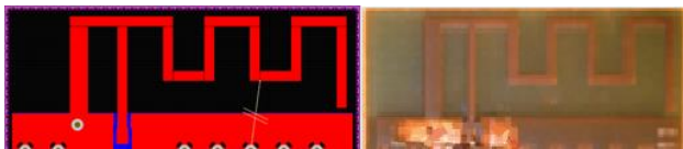
Slika 2. Prikaz dizajna antene i izrađene štampane ploče
