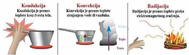
Slika 4. Ilustrativni prikaz načina prenosa toplote [5]
