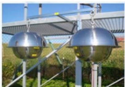
Slika 2: Pasivni uzorkivači vazduha postavljeni na lokaciji uzorkovanja [1]
