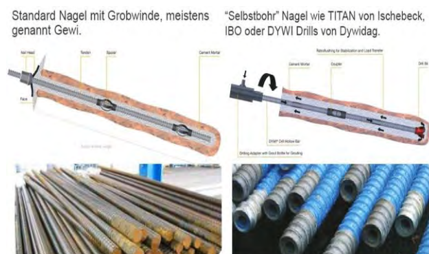
Слика 5: Анкер и такозвани „самобушени“ анкер [3]
