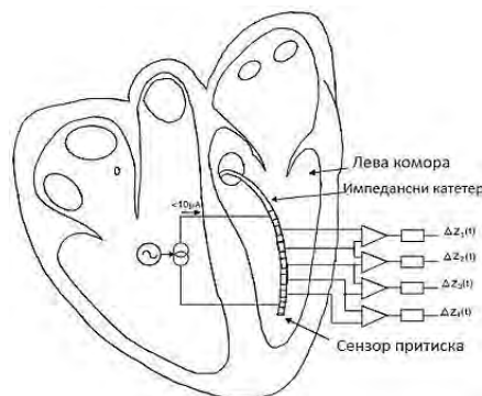
Слика 7. Приказ поступка мерења волумена леве коморе срца путем „проводног катетера“ користећи електроде уграђене у катетер за ињекцију константне струје
