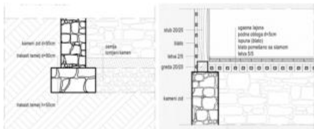
Slika 4. Vertikalni presek temelja, Poprečni presek međusp. tavanice (postojeće stanje)
