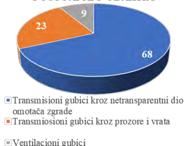
Slika 3. Energetski gubici na postojećem objektu
