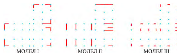
Слика 1. Распоред сеизмичких зидова према моделима
