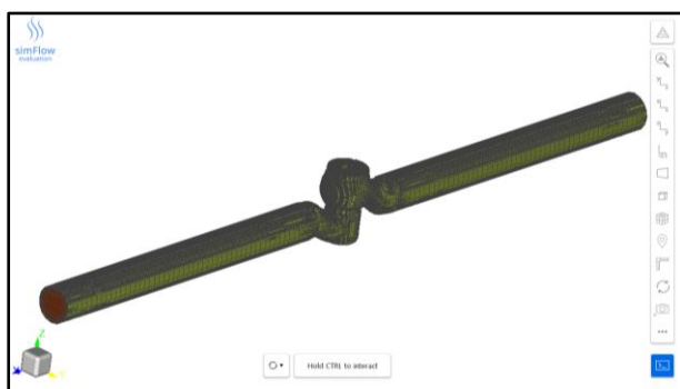
Slika 4. Model sa generisanom mrežom
