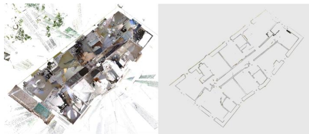
Slika 1. Uklanjanje neželjenih elemenata Point Cloud-a
