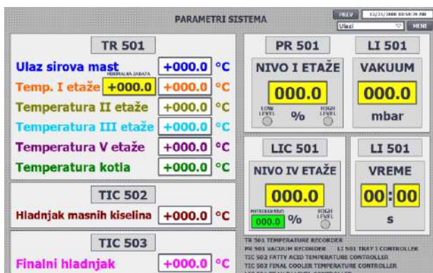
Слика 6. HMI визуализација – параметри система
