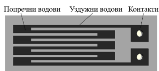
Слика 1. Изглед 3D штампане мјерне траке
