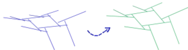
Slika 5: Prikaz korekcije položaja linija dinamičkom relaksacijom pomoću Kengaru3d
