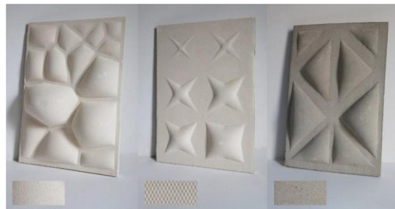
Slika 4. (levo) prvi gips prototip; (sredina) drugi gips prototip; (desno) betonski prototip
