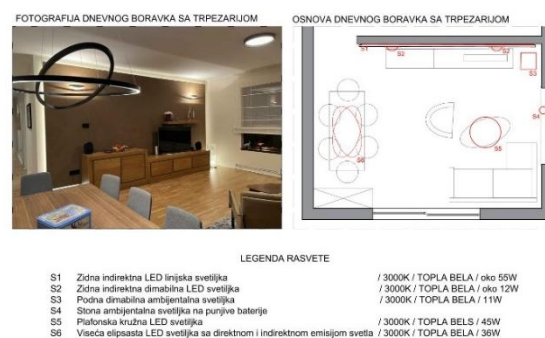
Slika 2. Analiza rasvete i osvetljenja
