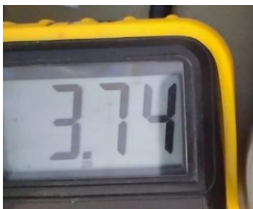
Slika 6. Izmerena vrednost napona na kondenzatoru pri napajanju od 5 V
